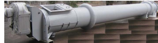
Hình 4.1a. Thiết bị làm mát xi đáy lò hơi công nghiệp, sử dụng làm thực nghiệm
