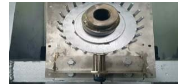
Hình 3.5: Ảnh cấu tạo lắp cảm biến đo vận tốc quay của trục
