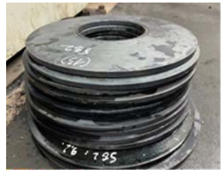
Hình 6: Chi tiết sau khi dập tạo hình
