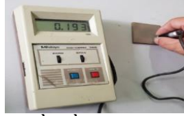
Hình 4.14. Chiều dày lớp phủ SiC-30Cu/C45. Phun có khí bảo vệ
