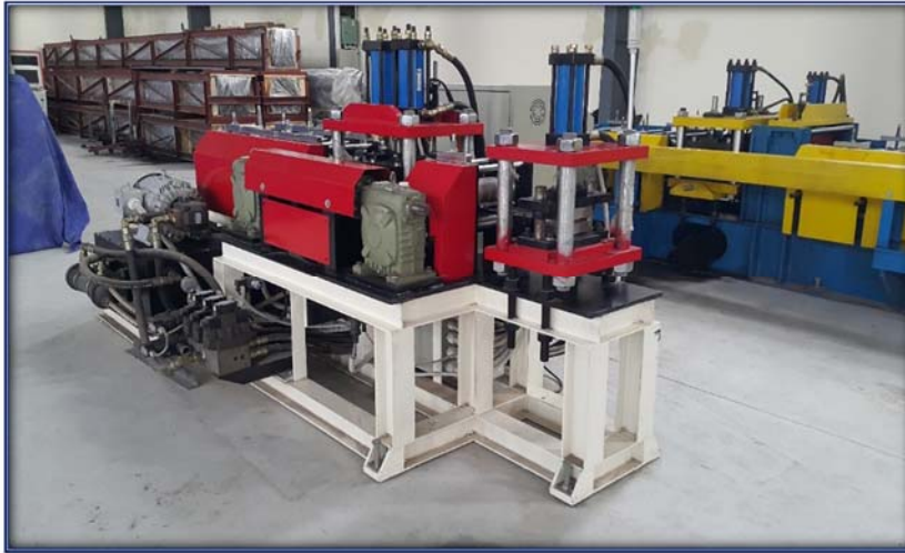
Máy sản xuất thanh cực phóng
