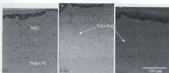
Hình 6: Ảnh chụp SEM của các mẫu lớp phủ sau khi thử nghiệm 168 giờ trong môi trường ăn mòn mài mòn
