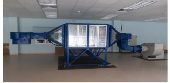
Hình 3.1. Ảnh mô hình vật lý lọc bụi bằng điện để thí nghiệm
