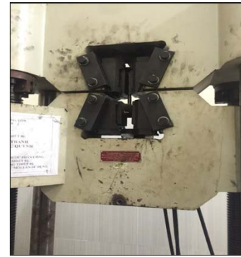
Hình 3.21. Kéo đứt chốt hàn trên máy thử kéo WEW 1000B
