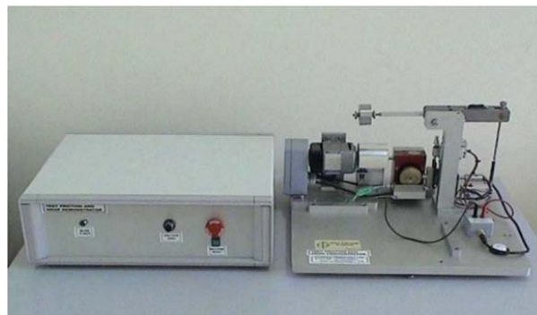
Hình 3.27. Thiết bị đo cường độ mòn và hệ số ma sát TE97- Friction
