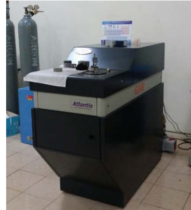
Hình 3.17. Thiết bị tia phổ phát xạ kiểm tra thành phần hóa học Metal Lab 75/80J MVU - GNR
