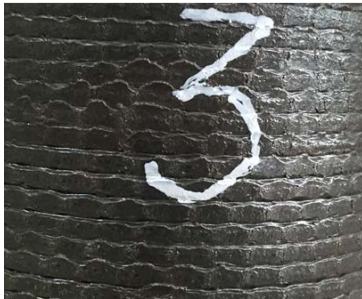
Hình 4.2. Bề mặt mối hàn M3: I_h = 6,5kA ; F = 2,3kN ; V_h = 2,0cm/s
