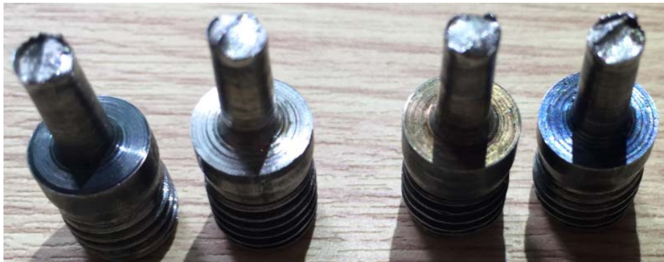
Hình 4.9. Bề mặt tách của chốt hình côn ra khỏi môi hàn
