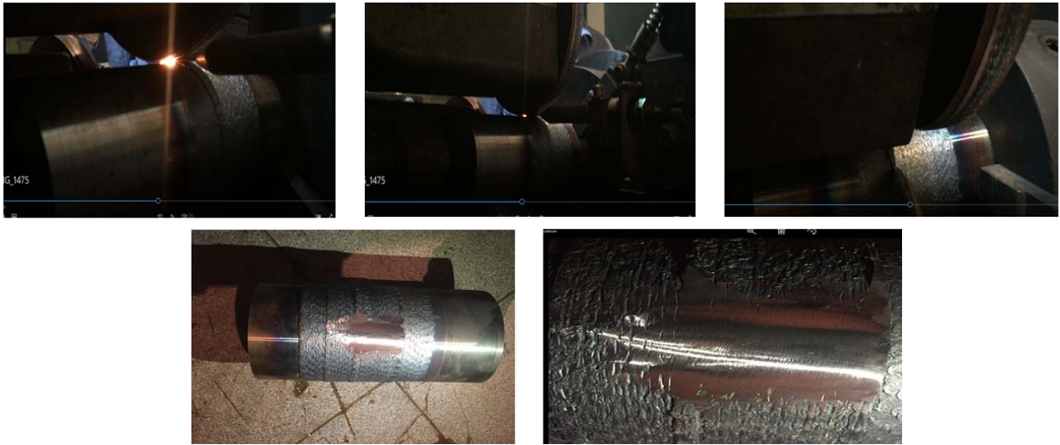
Hình 3.28. Hình ảnh quá trình và một số mẫu hàn thực nghiệm thăm dò
