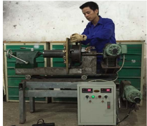
Hình 3.5. Lắp ráp và chạy thử nghiệm đồ gá
