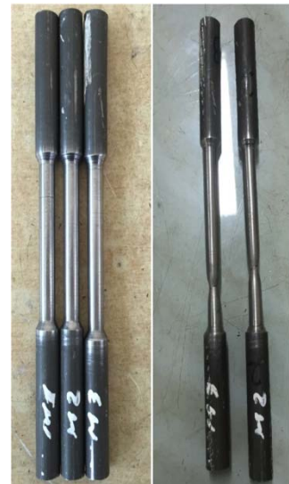
Hình 3.15. Mẫu thử kéo vật liệu chế tạo chốt
