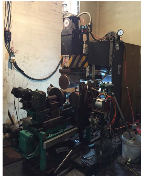
Hình 3.7. Hệ thống thiết bị hàn lăn tiếp xúc phục hồi chi tiết trực
