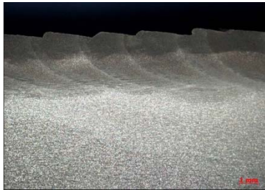
M1: I_h = 6,5kA ; F = 1,7kN ; V_h = 1,5cm/s
