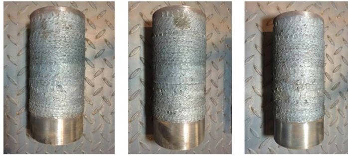
Hình 2.19. Các mẫu trục hàn với dòng điện hàn lớn
