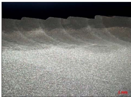
M1: I_h=6.5\text{kA} ; F=1.7\text{kN} ; V_h=1.5\text{cm/s}
