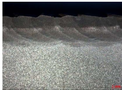
M2: I_h=6.5\text{kA} ; F=2.0\text{kN} ; V_h=1.75\text{cm/s}
