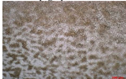
M2: I_h=6,5kA ; F=2,0kN ; V_h=1,75cm/s
