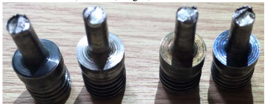
Hình 4.8. Bề mặt tách của chốt hình côn ra khỏi mỗi hàn
