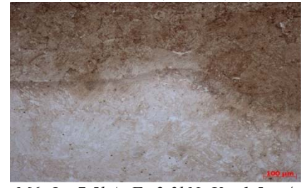
M6: I_h=7,5kA ; F=2,3kN ; V_h=1,5cm/s
