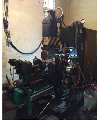
Hình 3.3. Hệ thống thiết bị hàn lăn tiếp xúc phục hồi chi tiết trục
