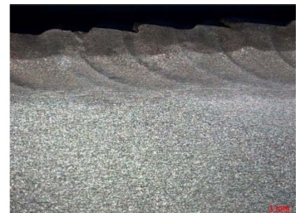
M3: I_h=6,5kA ; F=2,3kN ; V_h=2,0cm/s
