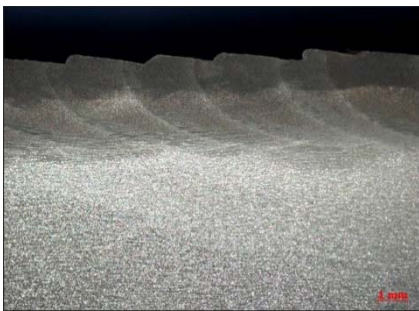
M1: I_h=6,5kA ; F=1,7kN ; V_h=1,5cm/s
