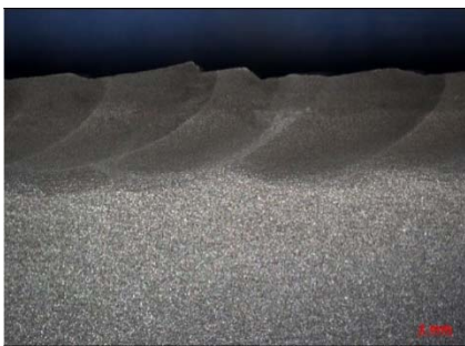
M4: I_h=7,5kA ; F=1,7kN ; V_h=1,75cm/s
