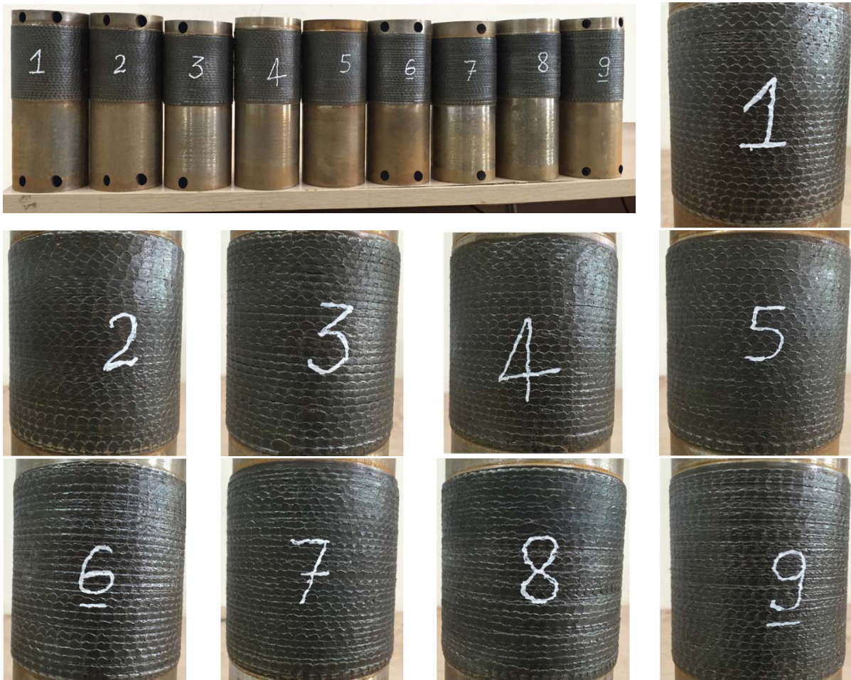
Hình 4.1. Mẫu hàn và bề mặt mẫu hàn thực nghiệm
