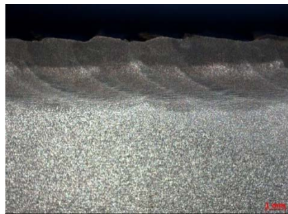
M2: I_h=6,5kA ; F=2,0kN ; V_h=1,75cm/s
