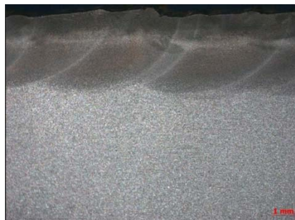
M8: I_h=8,5kA ; F=2,0kN ; V_h=1,5cm/s
