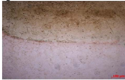
M2: I_h=6,5kA ; F=2,0kN ; V_h=1,75cm/s
