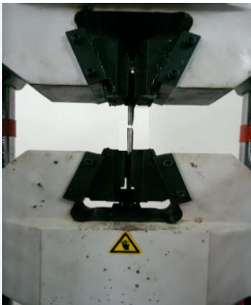
Hình 5.3. Kiểm tra độ bền kéo với chế độ hàn tối ưu
