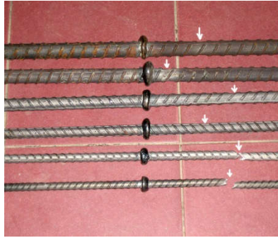
Hình 5.2. Kiểm tra độ bền kéo mối hàn tại công trường xây dựng
