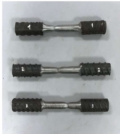
Hình 5.3. Kiểm tra độ bền kéo với chế độ hàn tối ưu
