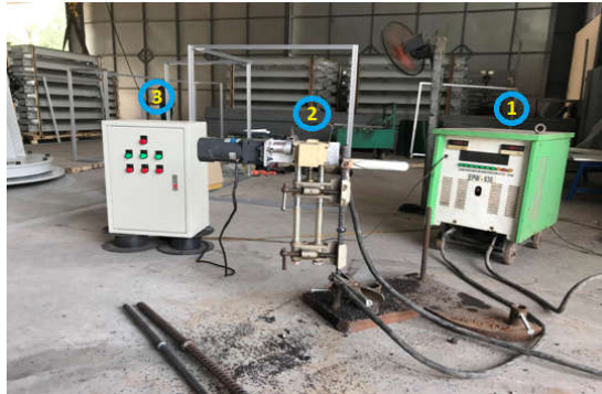
Hình 3.1. Nguyên lý cấu tạo của thiết bị hàn điện xỉ - áp lực dùng cho thí nghiệm của luận án: 1. Bộ nguồn hàn; 2. Đồ gá hàn; 3. Bộ điều khiển
