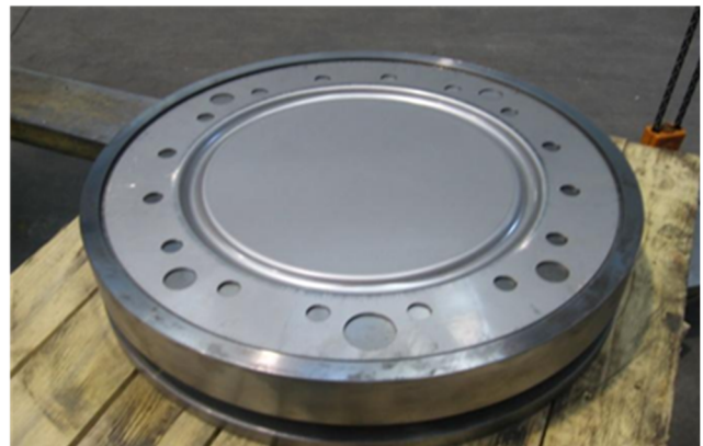
Hình 3: Màng đỡ - theo thiết kế của Alstom Hydro
