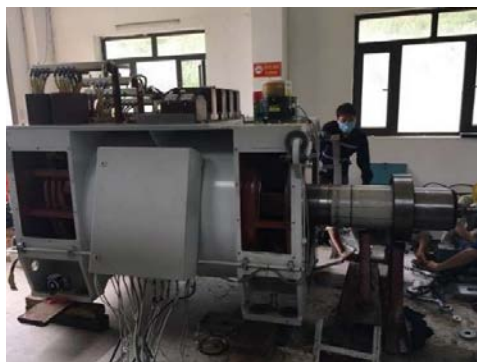
Hình 3. Máy phát điện có cổ trục bị mòn tại Nhà máy thủy điện Bản Xèo
