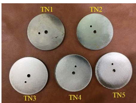
Hình 4. Mẫu thí nghiệm sau khi mạ
