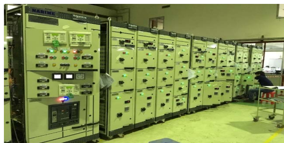
Hình 2: Tủ điện điều khiển động cơ băng tải do NARIME thiết kế và tích hợp trong nước.
